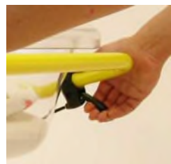
Photo 03: Levier relâché → Suspension bloquée
