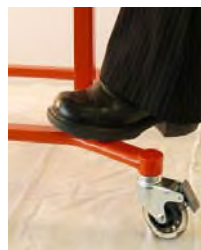
Photo 07 : Pédale poussée → Suspension libre → La nacelle se déplace vers le haut ou le bas
